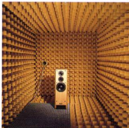
Forschung und Entwicklung im vollständig entkoppelten reflexionsarmen Meßraum
